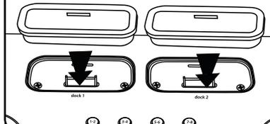
Scegliere l'adattatore per dock per il proprio modello di iPhone o iPod® nella tabella sottostante e inserire l'adattatore nel dock1/dock2. **Non posizionare mai nel dock l'iPhone/iPod senza utilizzare l'adattatore.**
