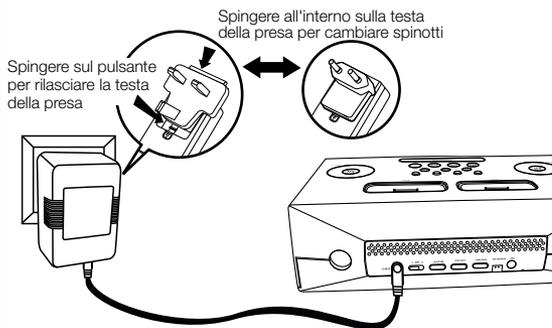
Inserire lo spinotto del cavo dell'adattatore CA nella presa a jack CC sulla parte posteriore dell'iP88 e la spina del suddetto adattatore in una presa di corrente.
